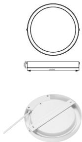
**Scheda tecnica Philips Downlight LED DN065C Metallo Bianca 19W 2000lm 110D - 840 Bianco Freddo | 225mm - Ritaglio 200mm - IP20**
