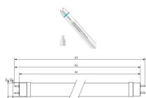
Scheda tecnica Philips Tubo LED T8 MASTER Value (EM/Mains) Ultra Output 15.5W 2500lm - 840 Bianco Freddo | 120cm - Sostitutiva 36W
