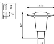
Scheda tecnica Philips Illuminazione stradale LED Lanterna City Charm Cono BDS490 Grigio 61W 6480lm 360D - 730 Luce Calda | IP66 - Simmetrico
