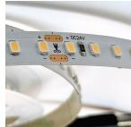
**Scheda tecnica Noxion Strisce LED SMD 120LEDs/M 120W 2230lm 24v - 960 Luce del Giorno | 5M/10mm - Miglior resa cromatica - Interni - Excl. Driver**
