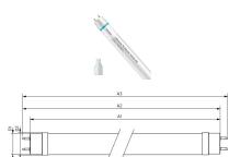
Scheda tecnica Philips Tubo LED T8 MASTER Value (EM/Mains) High Output 8W 1050lm - 865 Luce del Giorno | 60cm - Sostitutiva 18W
