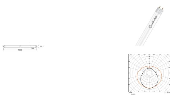
**Scheda tecnica Ledvance Tubo LED T8 EM Value Conventional (EM), Mains (AC) Standard Output 18.3W 2200lm - 865 Luce Del Giorno | 150cm - Sostitutiva 58W**
