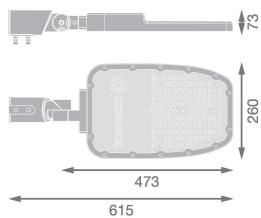
**Scheda tecnica Ledvance Illuminazione Stradale LED Area Large RV35ST Aluminium Grigio 90W 12150lm 155X69D - 765 Luce Del Giorno | IP66 - Asimmetrico**
