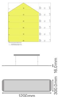
**Scheda tecnica Ledvance Pannello a LED Luce pendente 36W 3800lm - 830 Luce Calda | 120x30cm - UGR <19 - Dali Dimmerabile**
