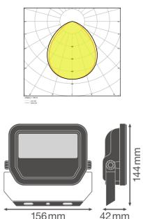
Scheda tecnica Ledvance Proiettore LED GEN 3 Bianca 20W 2400lm 100D - 840 Bianco Freddo | IP65 - Simmetrico - Sostitutiva 50W
