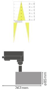
**Scheda tecnica Ledvance Luce a Binario LED D85 Bianca 35W 2660lm 24D - 930 Luce Calda | Miglior resa cromatica**
