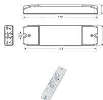
Scheda tecnica Osram LED driver Optotronica CV 1-10V | Dimmerabile
